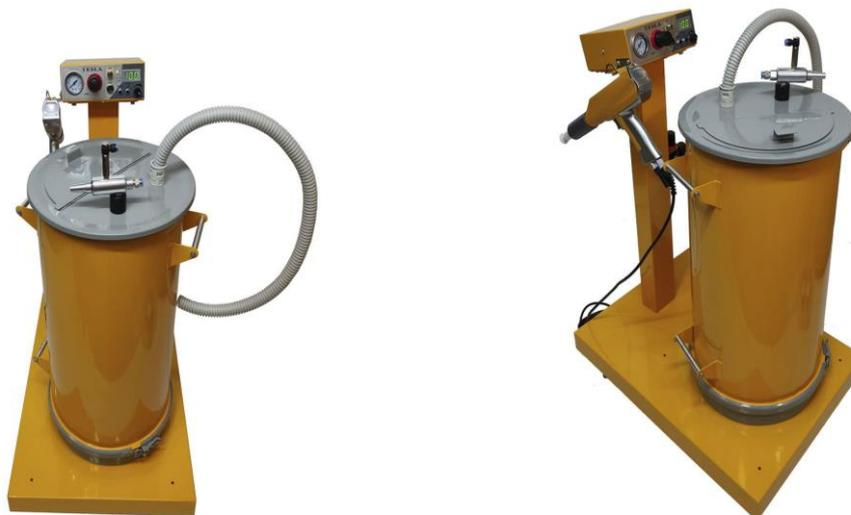
Все регулировки: подача порошка, транспортного воздуха, обдув коронирующего электрода, ожигание порошка в баке. Имеет на входе регулятор давления и фильтр масло-влаги отделиватель. Защита от высокого давления воздуха на входе для предотвращения разрушающего воздействия на пневмокомпоненты.
