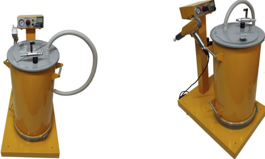
Все регулировки: подача порошка, транспортного воздуха, обдув коронирующего электрода, оживление порошка в баке. Имеет на входе регулятор давления и фильтр масловлаго отделитель. Защита от высокого давления воздуха на входе для предотвращения разрушающего воздействия на пневмокомпоненты.
