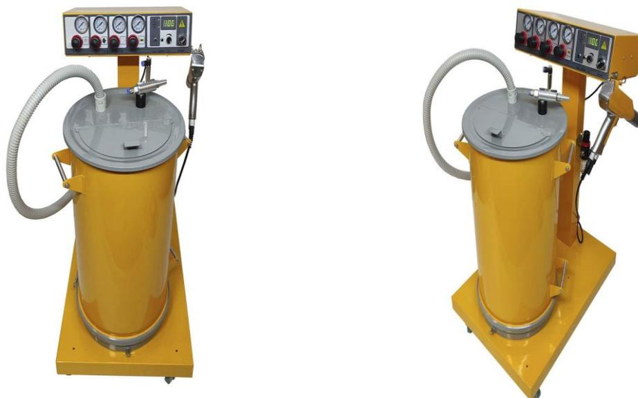
Может комплектоваться различными типами баков. Все регулировки на лицевой панели: подача порошка, транспортного воздуха, обдув коронирующего электрода, ожигение порошка в баке. Имеет на входе регулятор давления и фильтр масло-влаго отделитель. Платформа оснащена стопором колеса, что предотвращает случайное перемещение во время работы.
