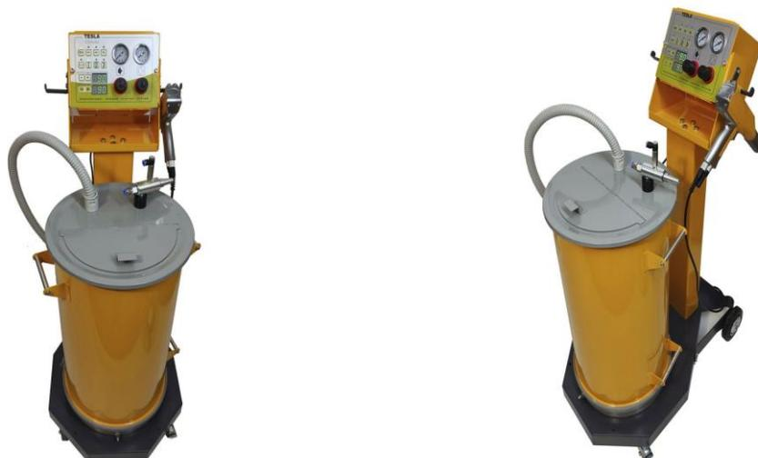
Высокопроизводительная, профессиональная, надежная и простая в эксплуатации ручная установка напыления порошковых красок в электростатическом поле с баком 50л. Возможность работы в трёх предустановленных режимах: для окрашивания плоских деталей, изделий сложной формы и перекрашивания. Точная цифровая настройка электрических параметров!
